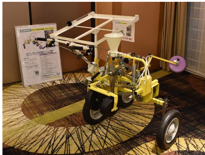
展示されたJAに整備した半自動野菜移植機。作業改善を図る低コストマシン。花菜、キャベツなどの定植作業軽減に向けた実演用機器。
