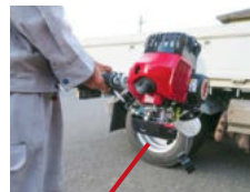
キャップを外して ガソリンを抜く
