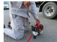
残留したガソリンは エンジンをかけて使い切る
