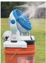
▲ 図1 ミストファン バケツの水を利用して、ミストを発生 (出典 農水省 熱中症関係情報集)
